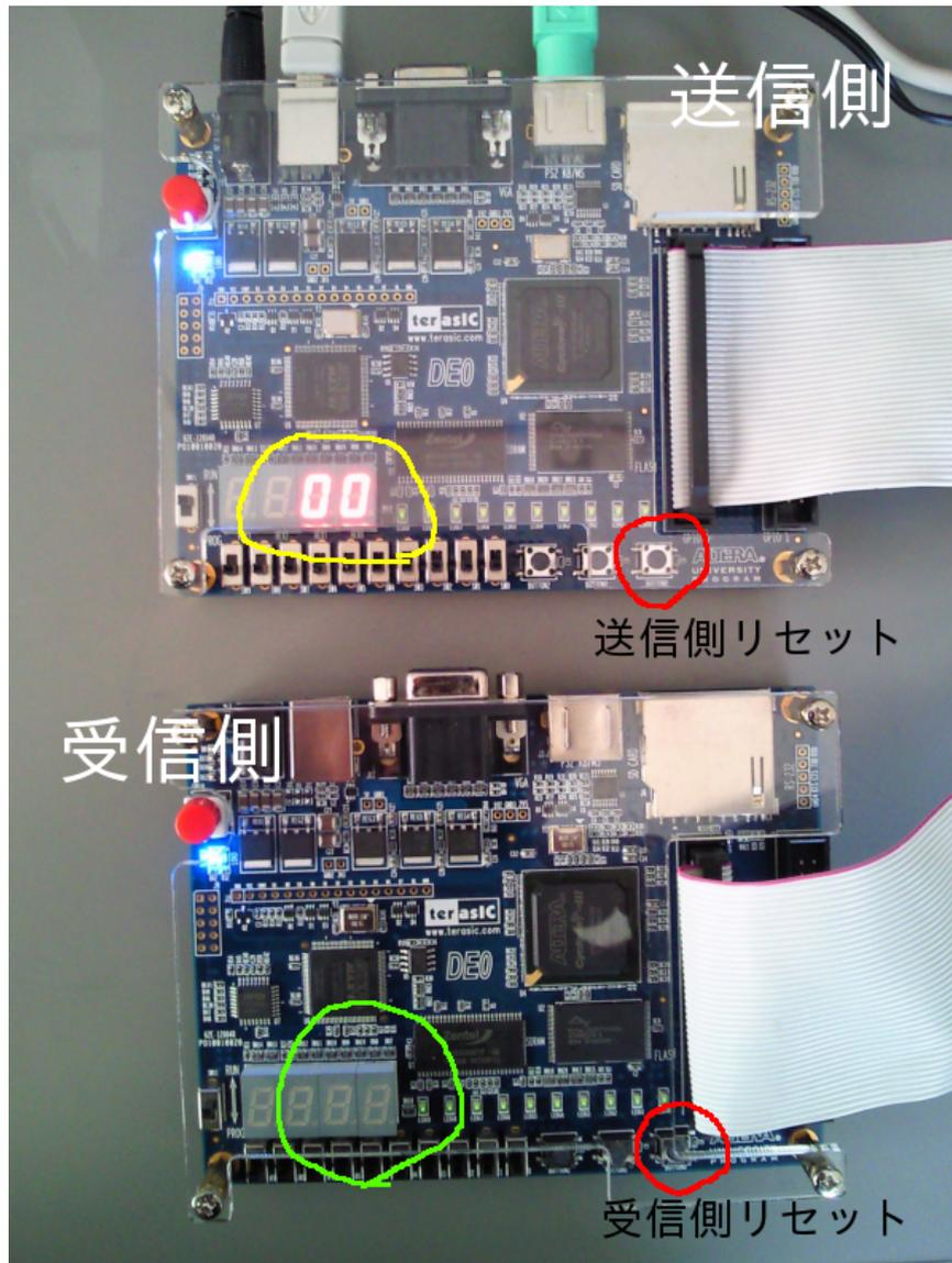
送信側、受信側双方で赤で囲んだリセットスイッチを押す。すると送信側の7セグメントLED(黄囲)は適当な設定値になり、受信側(緑囲)は消える。
