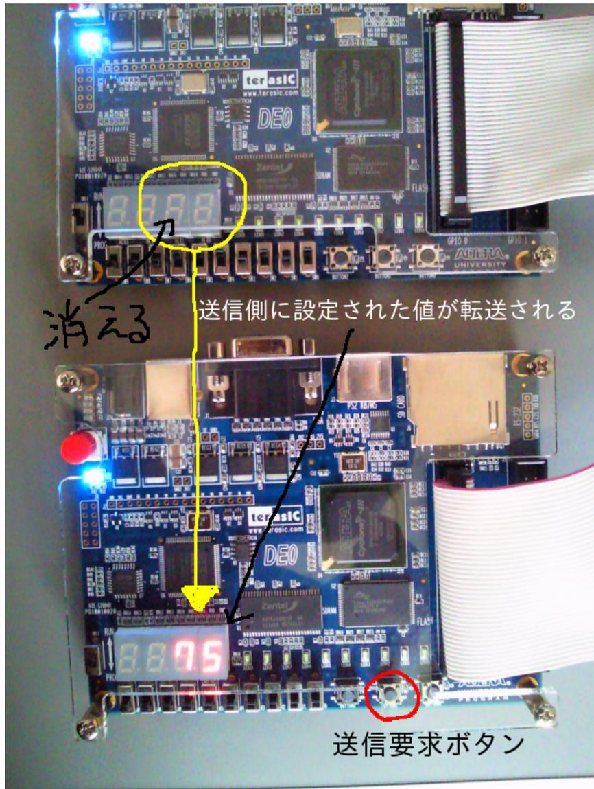
送信側で値を設定した後受信側の赤で囲んだ送信要求ボタンを押すと、送信要求を受けてデータが送信され、送信側の黄色で囲んだ部分に表示されていた設定データが受信側に転送され、送信側の表示が消える。
