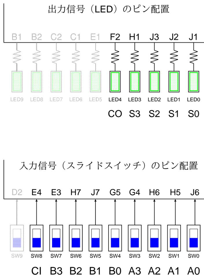
図3 4ビット並列加算器のピン配置
